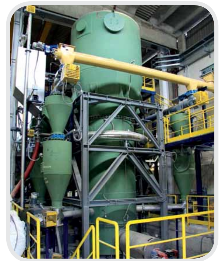
Esquema de funcionamiento e imagen gasificador de lecho fluido EQTEC Gasifier Technology
