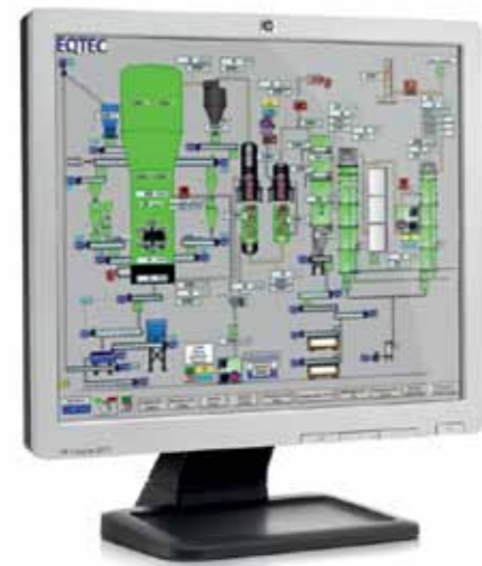
Imagen sistema de monitorización planta de gasificación de residuos agroindustriales, con indicación de las principales variables de funcionamiento. EMP se basa en la plataforma de hardware y software industrial SIEMENS.
