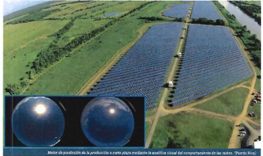
Motor de predicción de la producción a corto plazo mediante la análisis visual del comportamiento de las nubes. (Puerto Rico)
